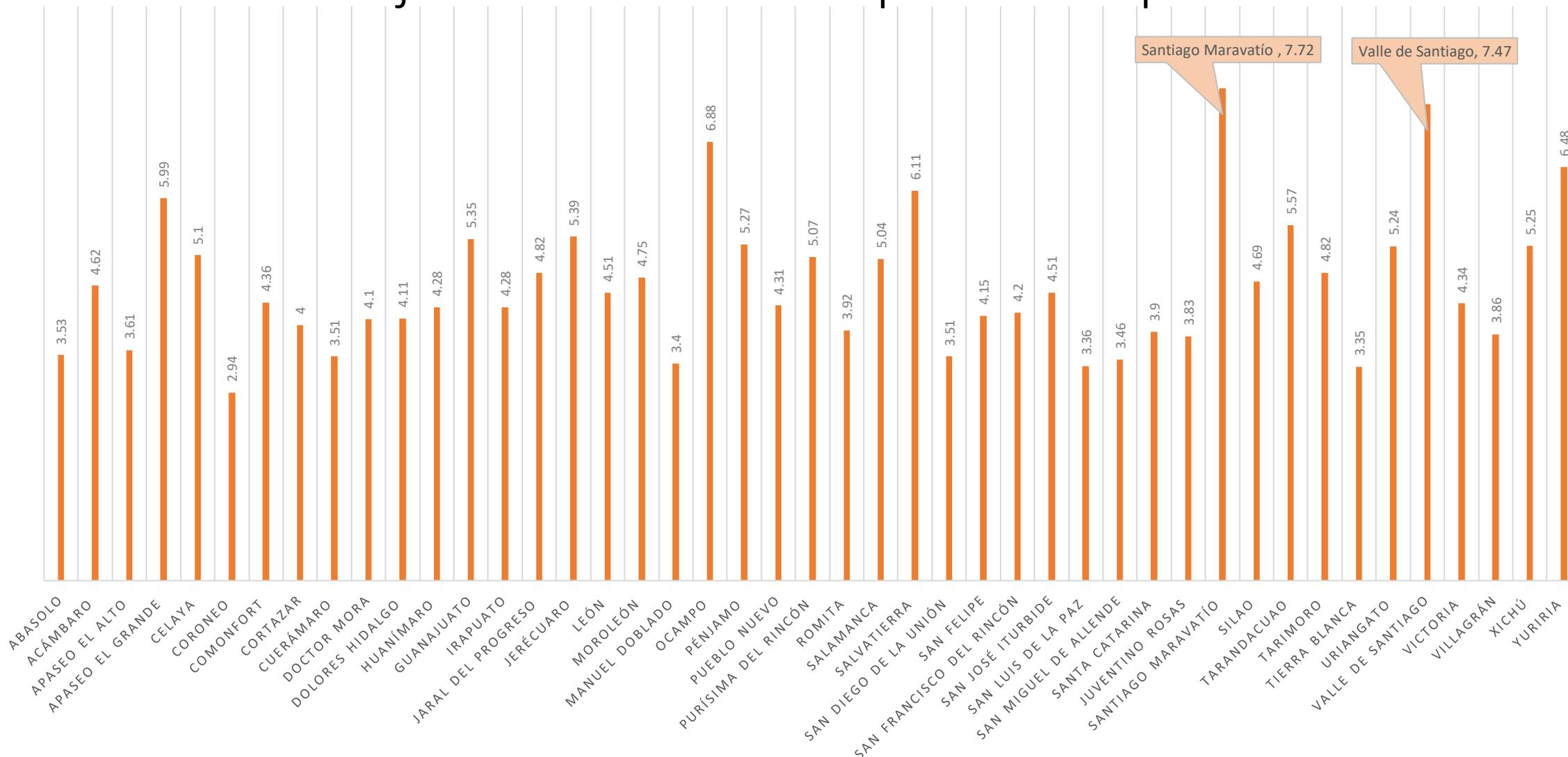
El IRI promedio es el valor promedio del Índice de Rugosidad Internacional medido en un tramo de carretera. Es una medida importante para evaluar la calidad del pavimento, ya que un valor alto indica que el pavimento está en mal estado y puede afectar negativamente la seguridad y comodidad de los usuarios.
